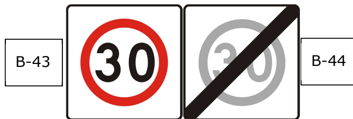
Rys. 2.16 Znaki oznaczające wlot i wylot strefy tempo 30
