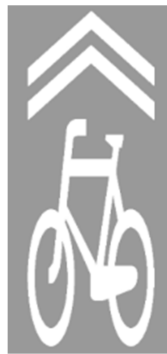
Rys. 2.4 Projekt znaku P-27 określającego „kierunek i tor ruchu” rowerzysty [14]
