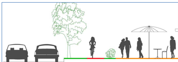
Rys. 2.9 Przekrój drogi z wydzieloną drogą rowerową
