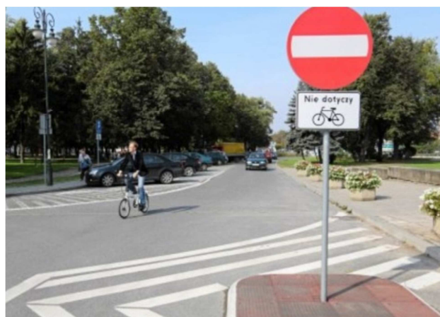
Rys. 2.3 Przykład dopuszczenia ruchu „pod prąd” dla rowerów [12]
