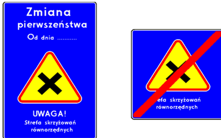
Rys. 2.17 Znaki oznaczające wlot i wylot ze strefy skrzyżowań równorzędnych
