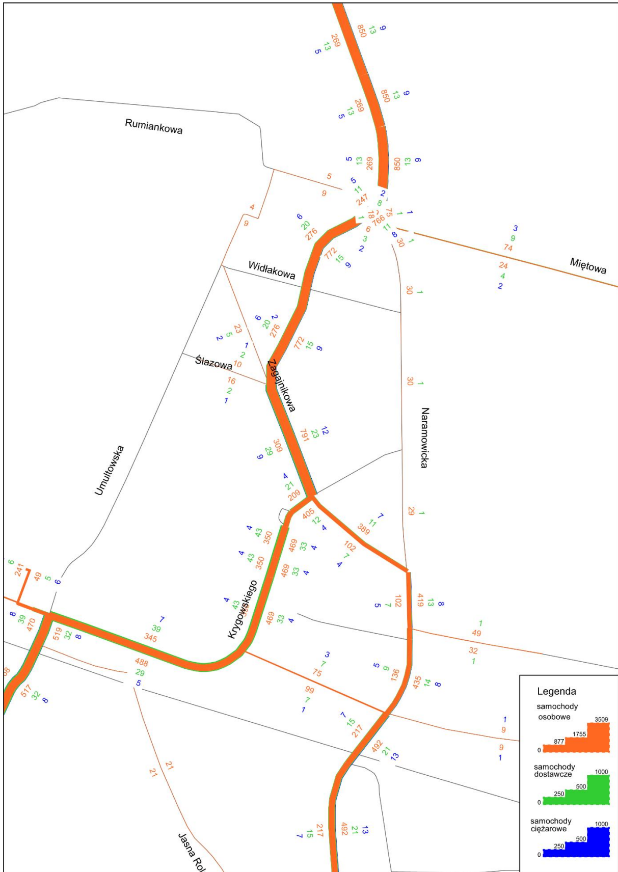
Rysunek 17. Stan 2035 zamknięcie ul. Umultowska. Rozkład ruchu samochodowego w szczycie popołudniowym 15:00-16:00; [pojazdów/h].
