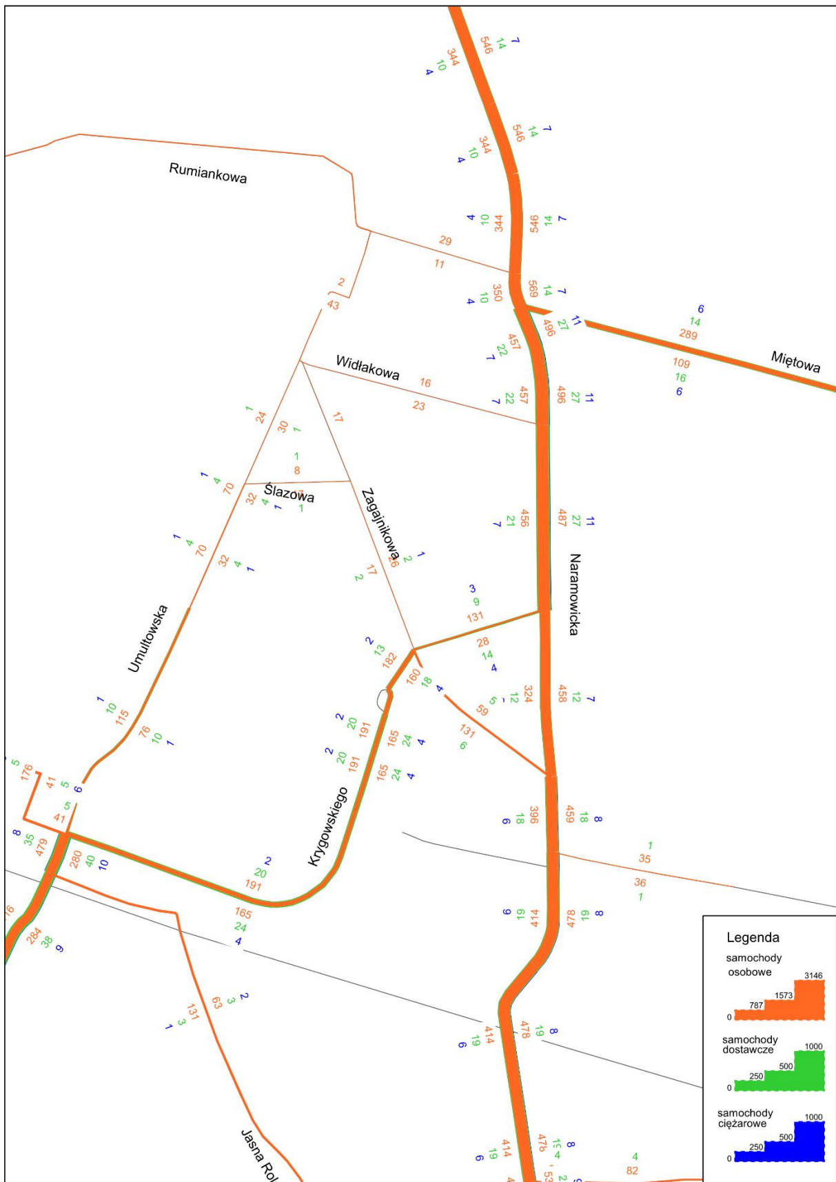
Rysunek 12 Stan 2025 przebudowa ul. Umultowska. Rozkład ruchu samochodowego w szczycie popołudniowy 15:00-16:00; [pojazdów/h]
