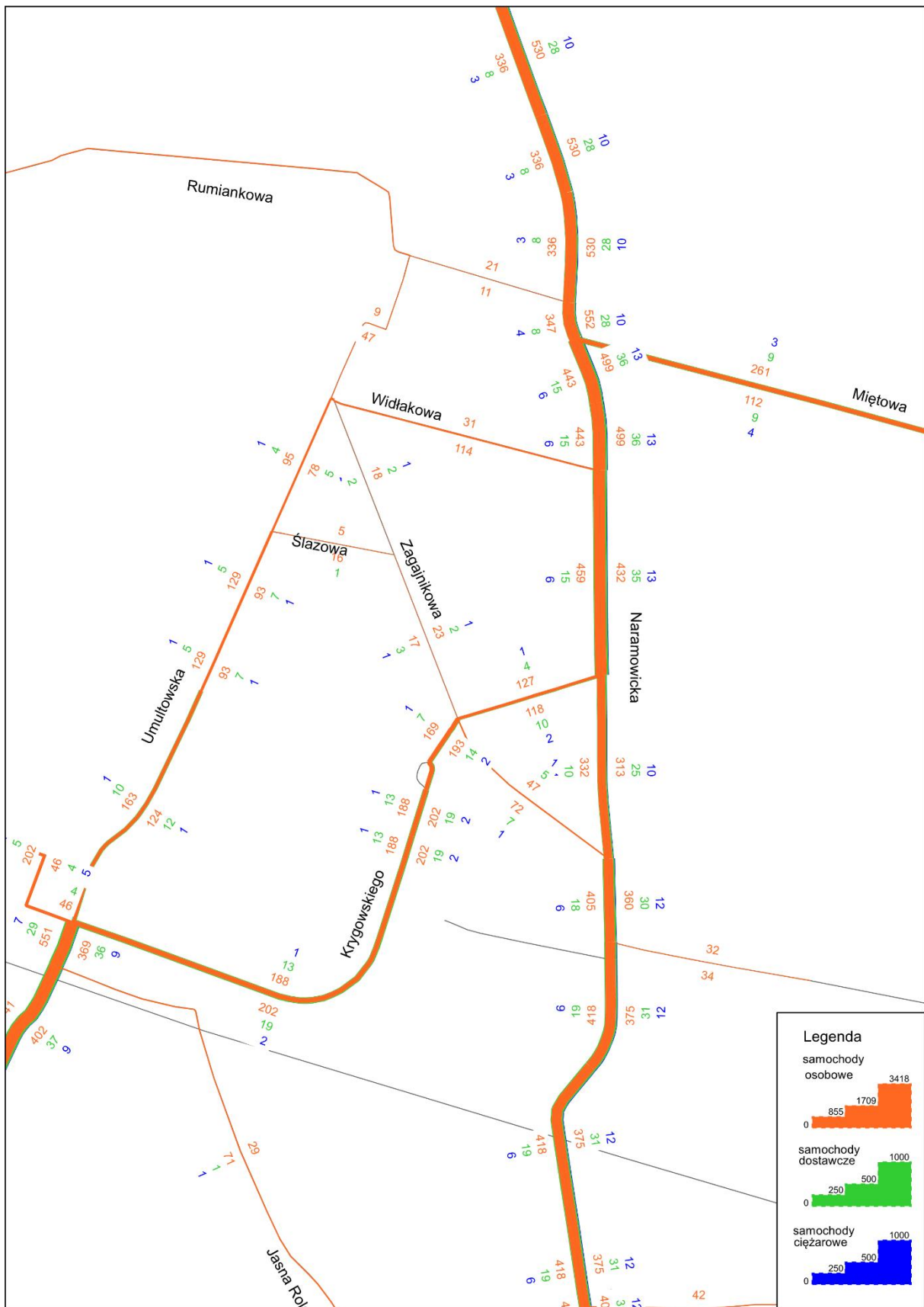
Rysunek 6 Stan istniejący 2019 przebudowa ul. Umultowska.. Rozkład ruchu samochodowego w szczycie popołudniowy 15:00-16:00; [pojazdów/h]
