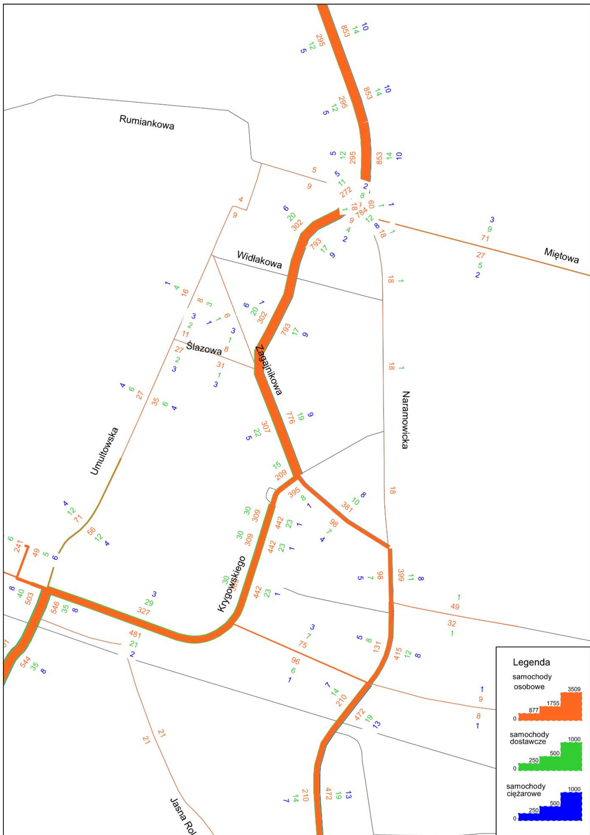
Rysunek 18 Stan 2035 przebudowa ul. Umultowska. Rozkład ruchu samochodowego w szczycie popołudniowym 15:00-16:00; [pojazdów/h].
