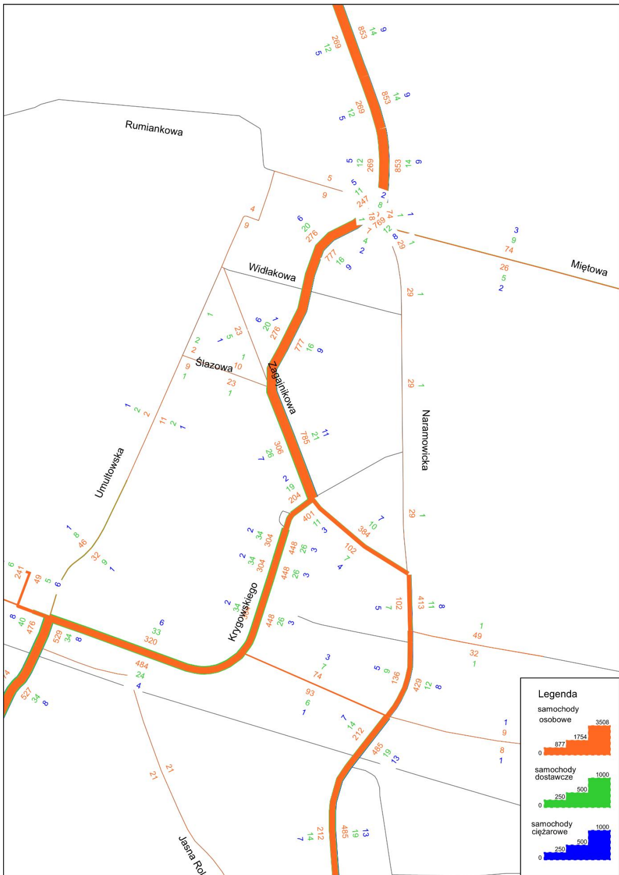
Rysunek 16 Stan 2035. Rozkład ruchu samochodowego w szczycie popołudniowym 15:00-16:00; [pojazdów/h].
