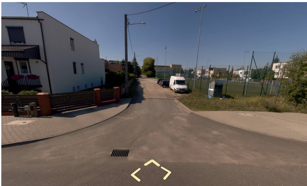
Fot.1 Widok w kierunku południowym ulicy Hiacyntowej od strony skrzyżowania z ulicą Floksową. Widoczny zjazd wraz z tarczą skrzyżowania z nawierzchni bitumicznej oraz chodnik wzdłuż południowej krawędzi ulicy Floksowej z betonowej kostki typu „BEHATON”. Brakujący fragment dowiązania chodnika po prawej stronie zjazdu zostanie wykonany w ramach obecnego Projektu.
