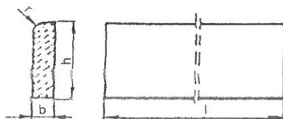
Rysunek 1. Kształt betonowego obrzeża chodnikowego
