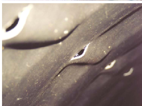
Rys. 5.31. Deformacje, pęknięcia elementu rurowego
